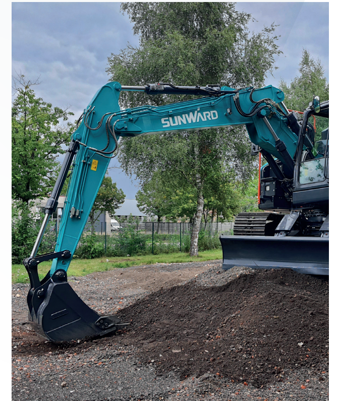
Les axes du balancier et du godet sont conçus pour une durée d'exploitation standard de 20 000 heures.
